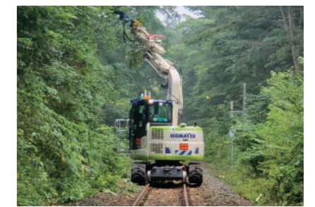
「SLANETRAC HC150」は2~8tの建設機械に装着する草刈りアタッチメント。調整可能な取り付けブラケットを採用しているため水平から垂直の間の任意の角度で切断できる。線路脇以外でも使用可能で空間を伐採するのに最適だ。
