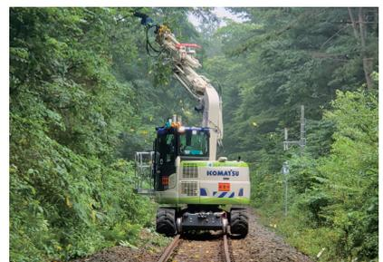
『SLANETRAC HC150』は2～8tの建設機械に装着する草刈りアタッチメント。調整可能な取り付けブラケットを採用しているので水平から垂直の間の任意の角度で切断できる。線路脇以外にも使用可能で空間を伐採するのに最適だ。
